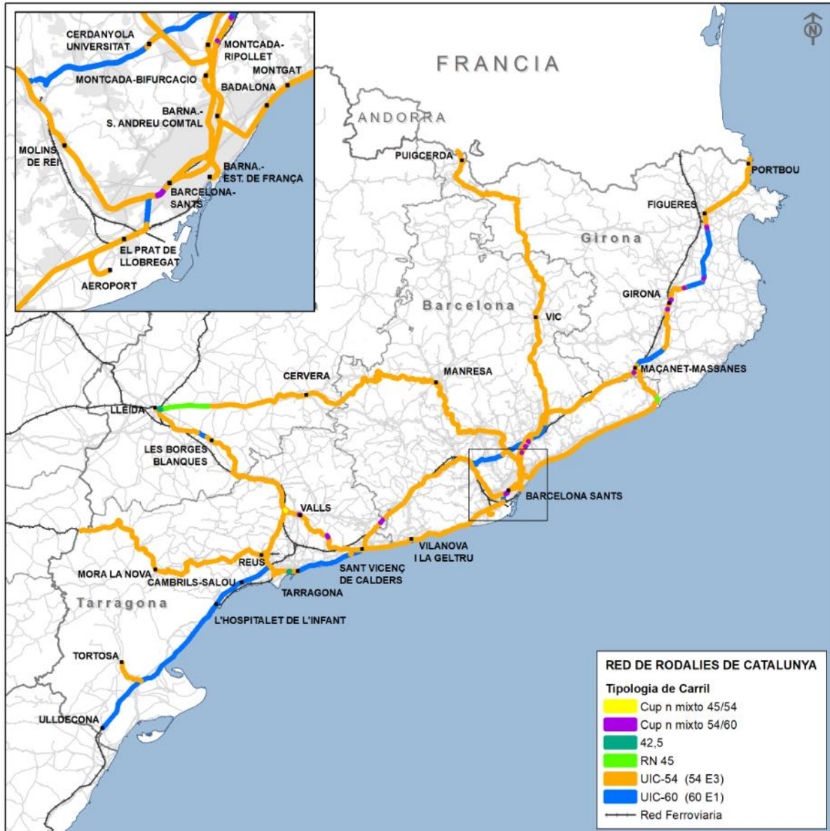
Figura 56.- Tipología de carril en la Red de Rodalies de Catalunya
