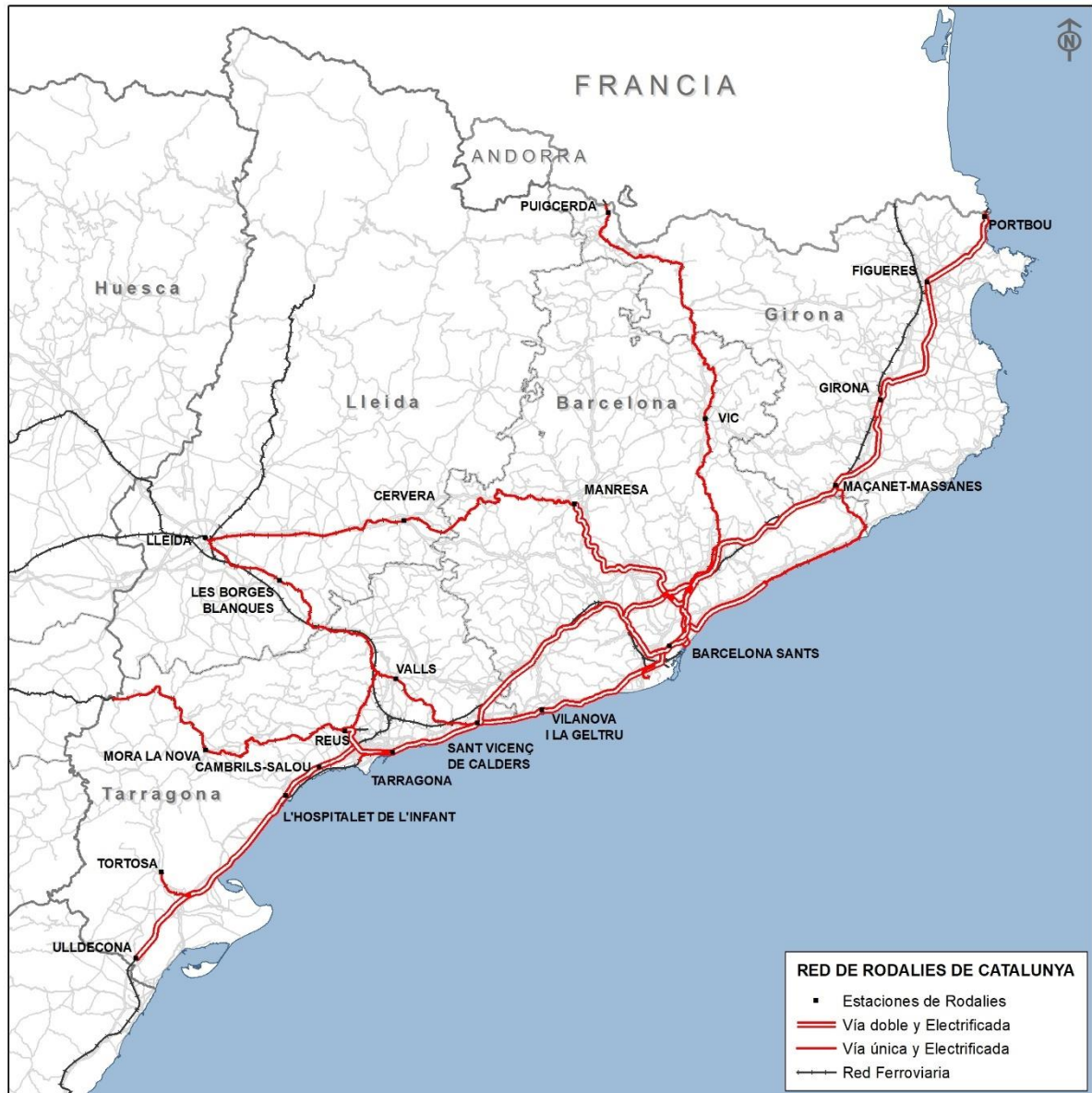
Figura 58.- Tipo de vía en la Red de Rodalies de Catalunya
