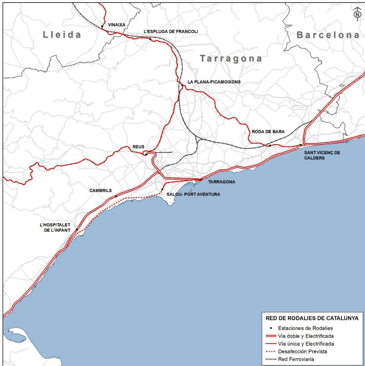
Figura 60.- Tipo de vía en la Red de Rodalies de Catalunya. Área de Tarragona
