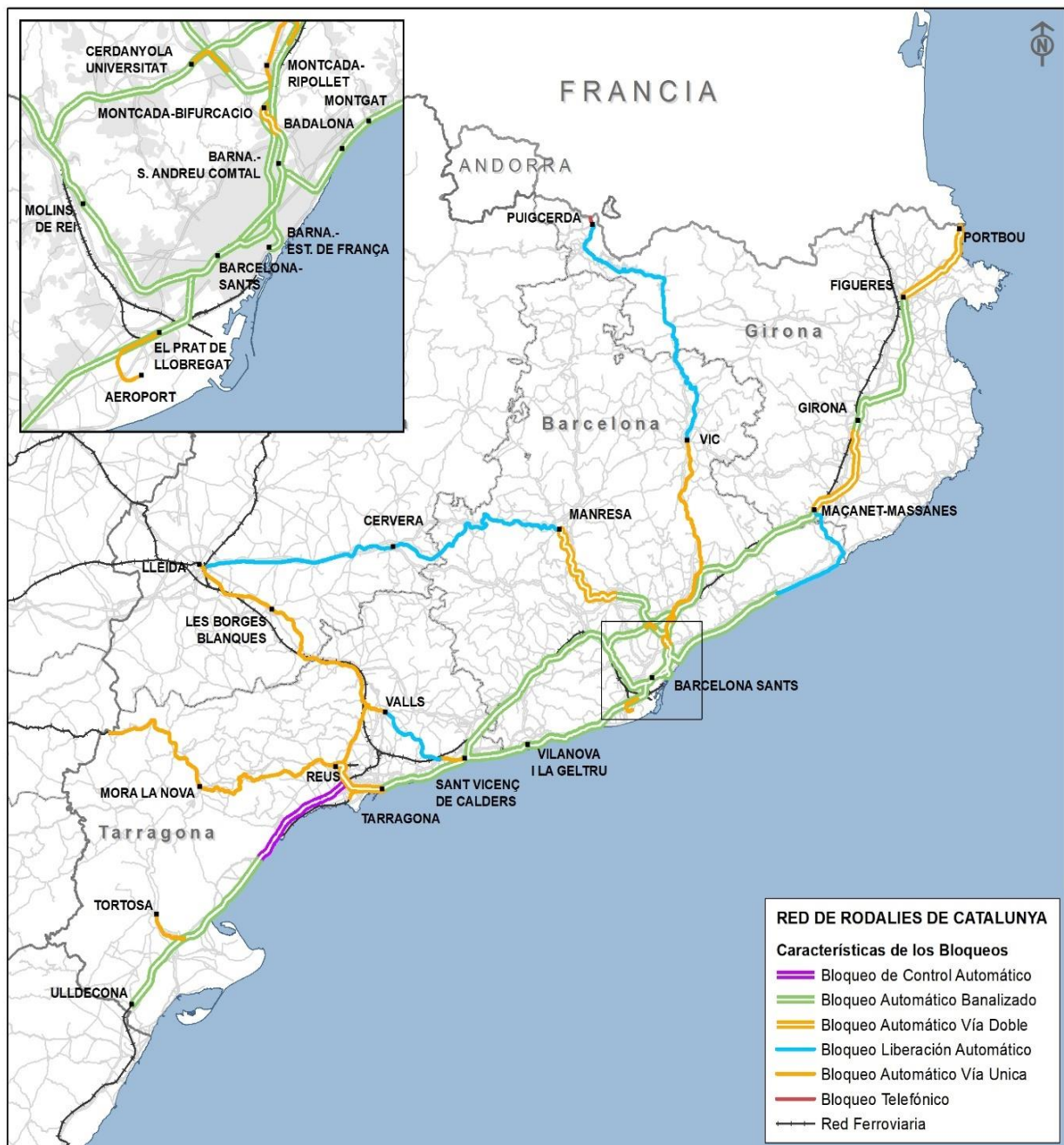
Figura 64.- Tipo de señalización en la Red de Rodalies de Catalunya
