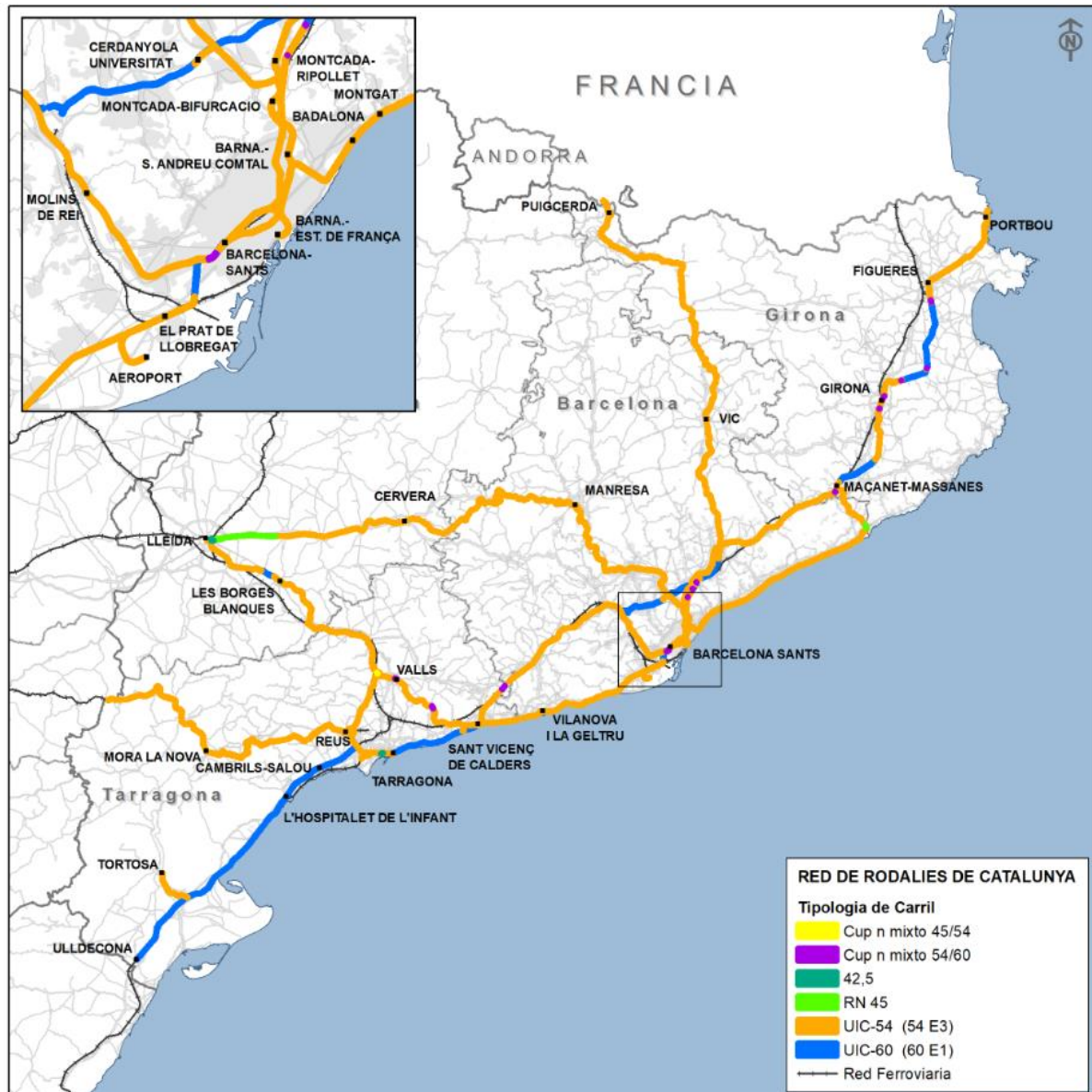
Figura 56.- Tipologia de carril a la Xarxa de Rodalies de Catalunya
