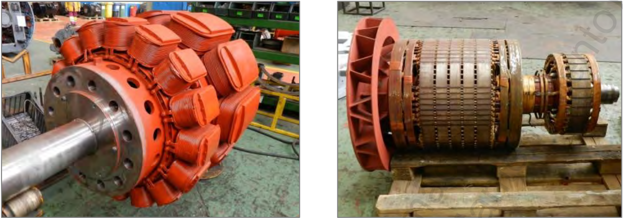
Figura. 2-21 Ejemplos de rotor de polos salientes y de polos lisos
