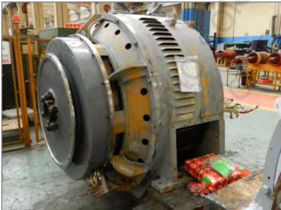
Figura. 2-11 Alternador Síncrono y Rotor de Polos Salientes
