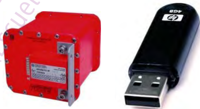
Figura 1-15. Módulo de memoria rugerizada y Pendrive para la extracción de datos
