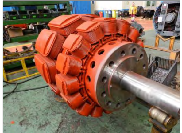
Figura. 2-11 Alternador Síncrono y Rotor de Polos Salientes
