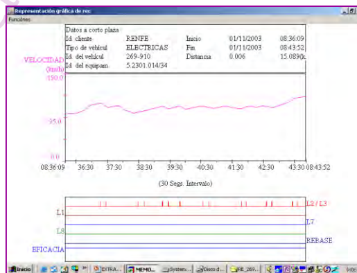
Figura 1-23. Memotel. Pantalla de visualización de datos.
