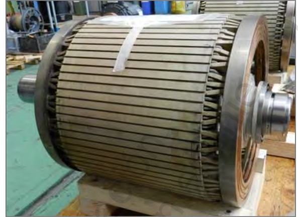
Figura. 2-11 Motor Asíncrono y Rotor de Jaula de Ardilla
