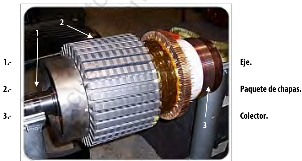
Figura. 1-7 Conjunto Rotor o Inducido
