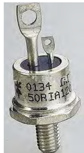
Figura 1-40. Tiristor rosca tipo AVR/ AFR 20 Amperios.
