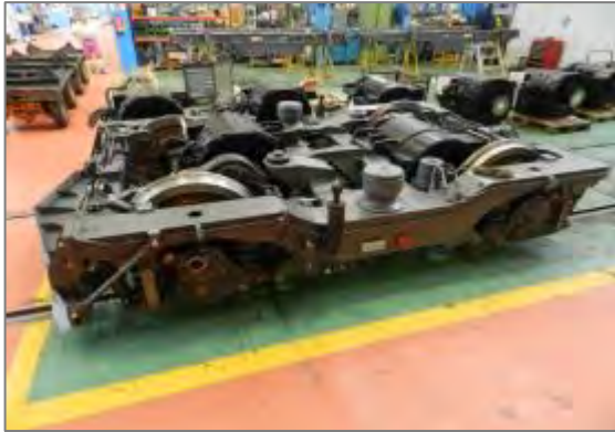
Figura. 1-23 Un motor en cada eje
