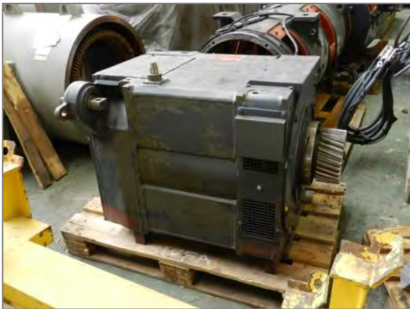
Figura. 2-12 Motor Síncrono y rotor Bobinado de polos lisos
