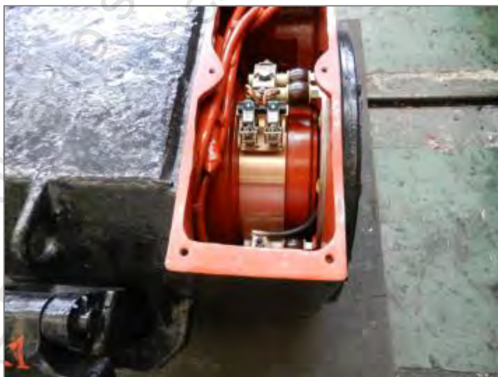
Figura. 1-12 Conjunto porta-escobillas sobre colector
