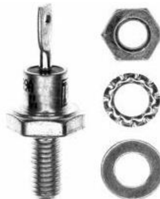
Figura 1-30. Diodo Rosca tipo AVR /AFR 25 Amperios.
