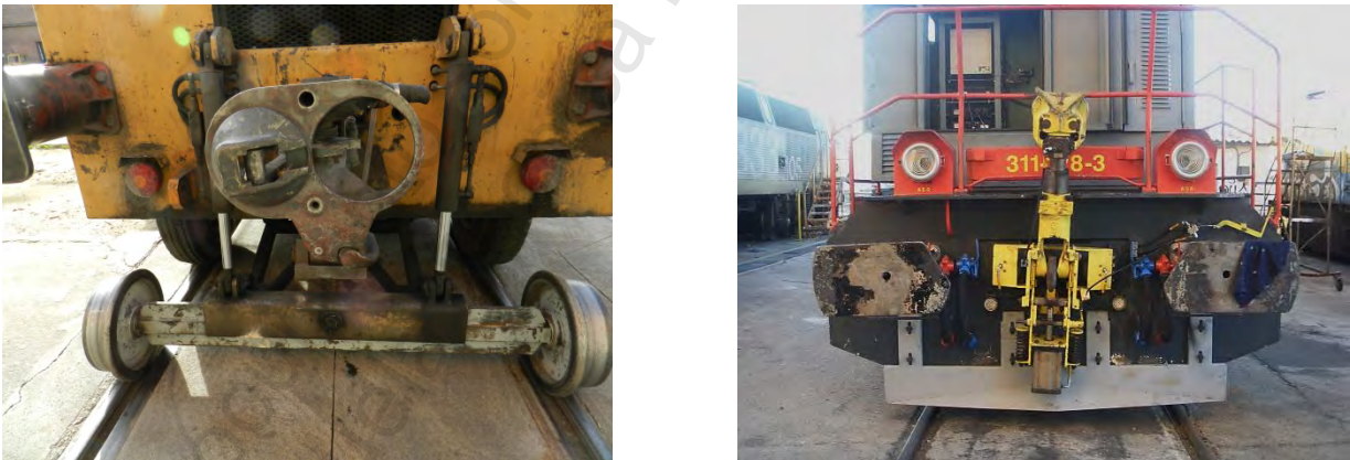
Figura. 5-32 Enganche auxiliar para maniobras. En locotractor (izquierda). En locomotora (derecha)
