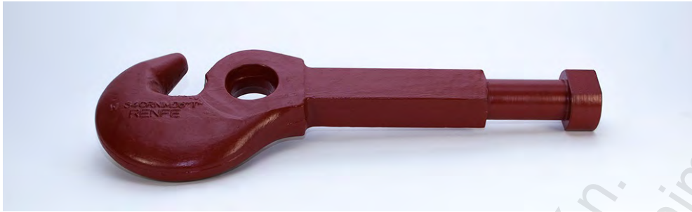
Figura. 5-4 Gancho de tracción desmontado
