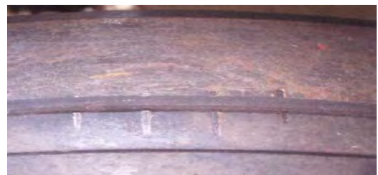
Figura. 9-27 Marcas de origen indeterminado que pueden ocasionar fisuras
