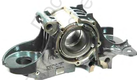
Caja de grasa equipada con unidad de rodamientos para conjunto eje/rueda sensorizada para los últimos trenes Pendolino italianos
