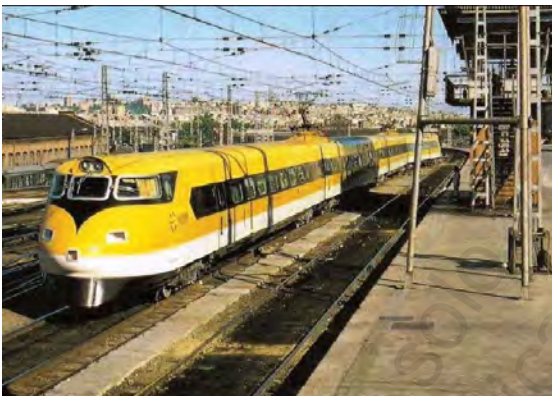
Figura. 4-11 Vehículos con sistema de basculación FIAT-ALSTOM
