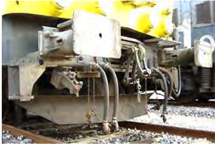
Figura. 5-33. Vehículo con traviesa fusible
