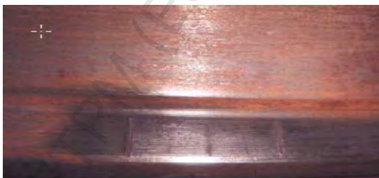
Figura. 9-27 Marcas de origen indeterminado que pueden ocasionar fisuras
