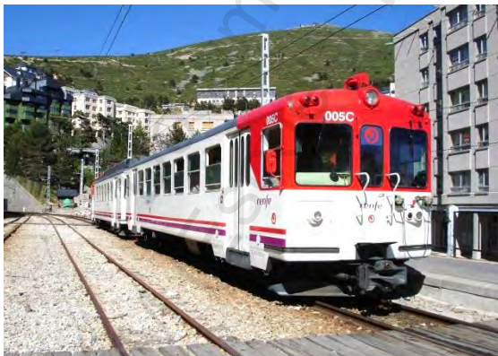
Figura. 5-28 Enganche mecánico con acoplamiento neumático
