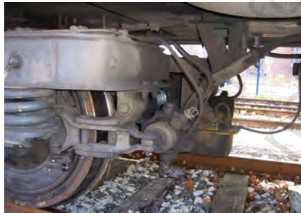
Figura. 2-63 Disco de freno en velo de rueda de locomotora
