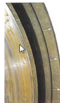
Figura. 9-32 Desplazamiento de material
