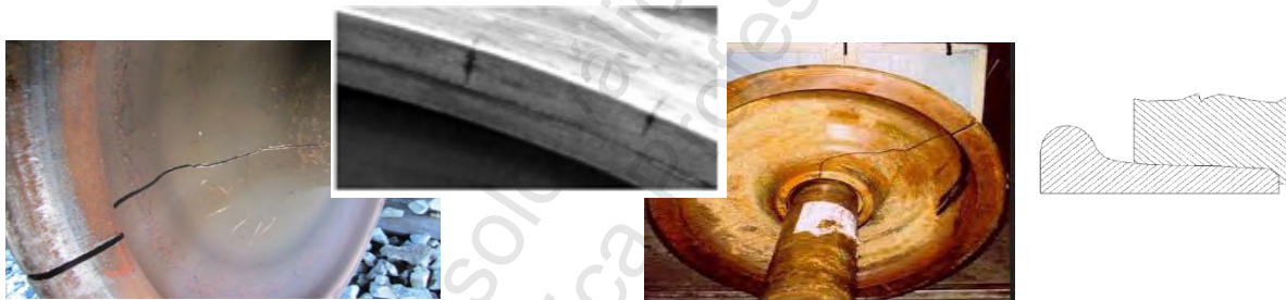
Figura. 9-24 Rotura de ruedas por fisuras de origen térmico en la cara exterior
