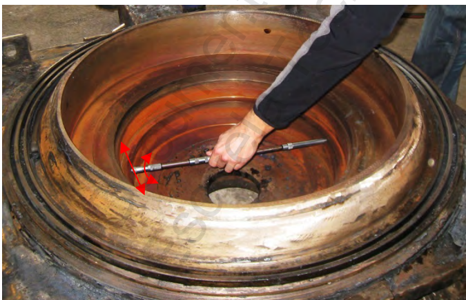
Figura. 2-30 Movimiento de vaivén para posicionamiento de micrómetros
