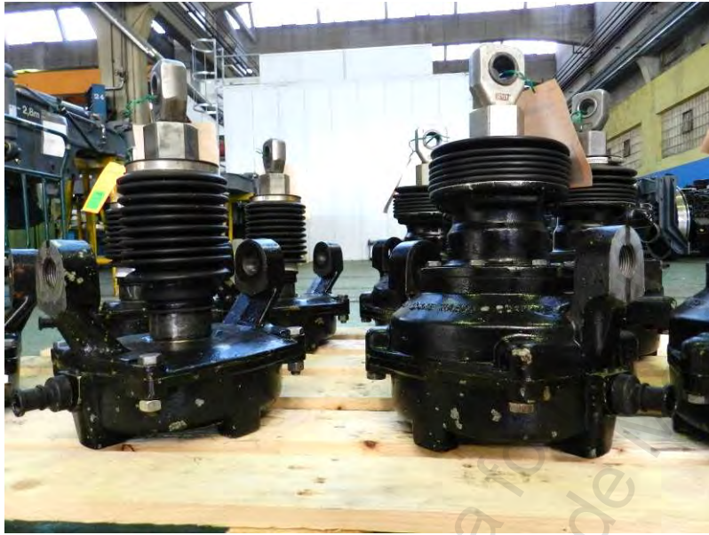
Figura. 2-65 Cilindros de freno sin y con sistema de freno de estacionamiento
