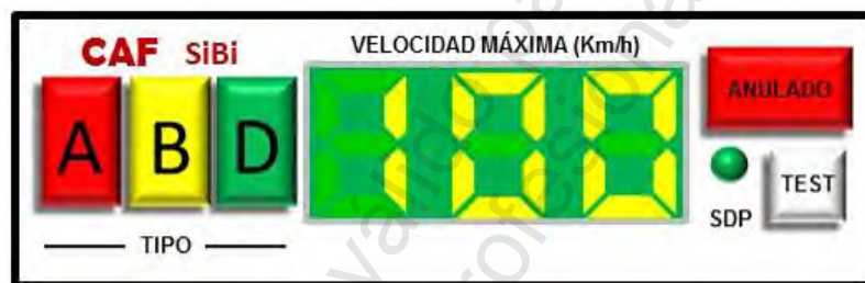
Figura. 4-14 Detalle de actuador de pupitre del sistema SIBI
