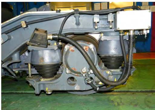
Figura. 2-45 Ejemplos de unión goma/caucho y metal
