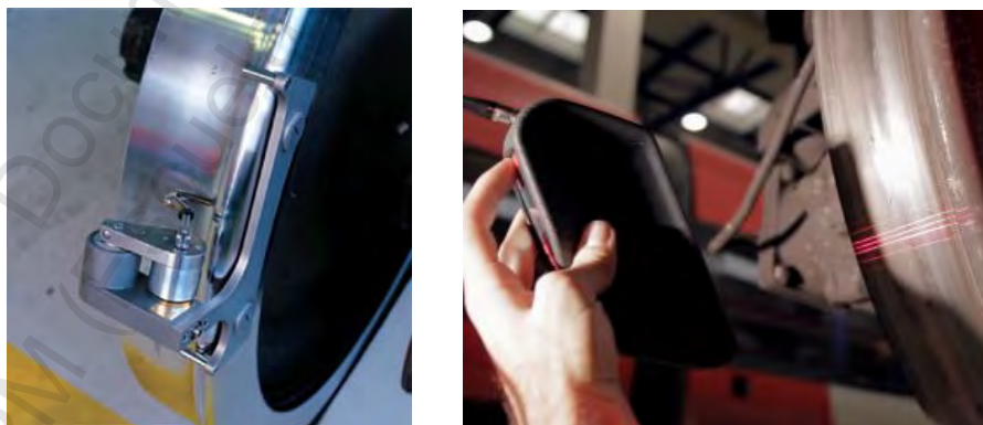
Figura. 2-20 MiniProf (izquierda) y Calipri Laser (derecha)
