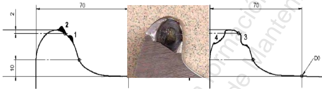
Figura. 9-10 Defectos en el borde de la pestaña
