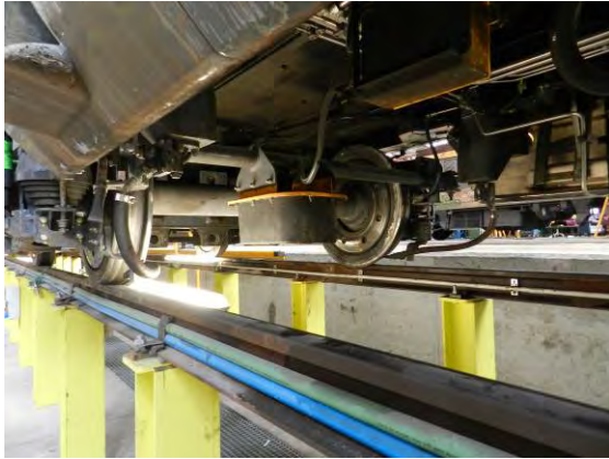
Figura. 2-76 Captadores de ASFA bajo vehículo autopropulsado
