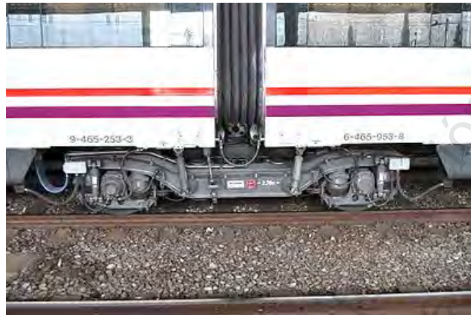
Figura. 3-7 Bogie compartido de vehículo autopropulsado
