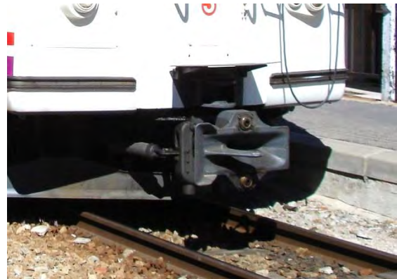
Figura. 5-28 Enganche mecánico con acoplamiento neumático
